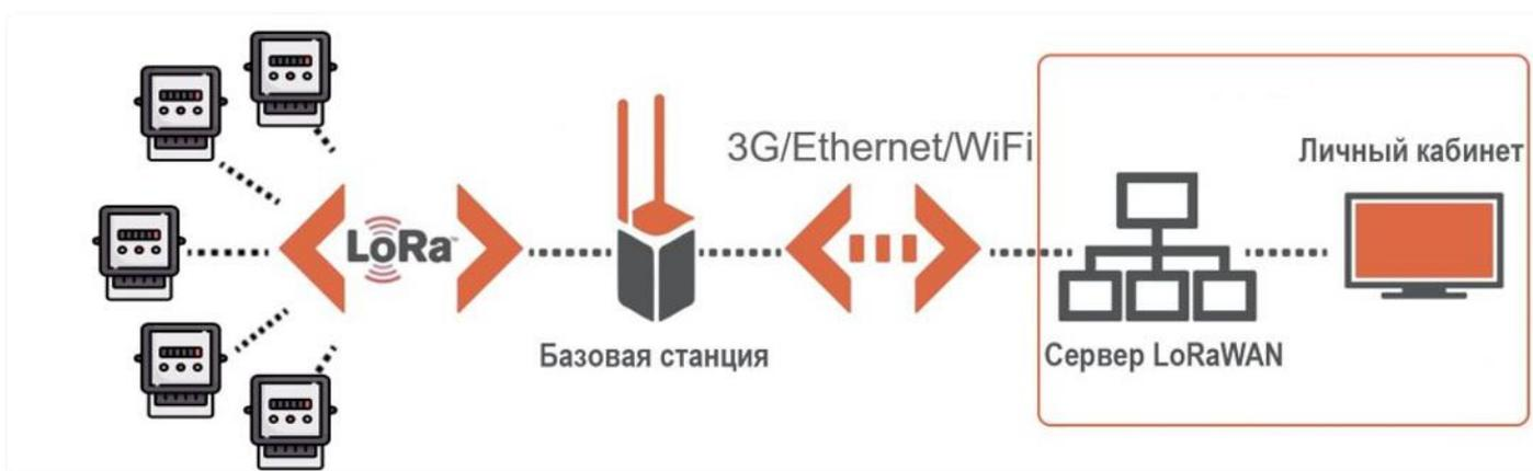
Рисунок отображает схему работы и взаимодействие между узлами.
